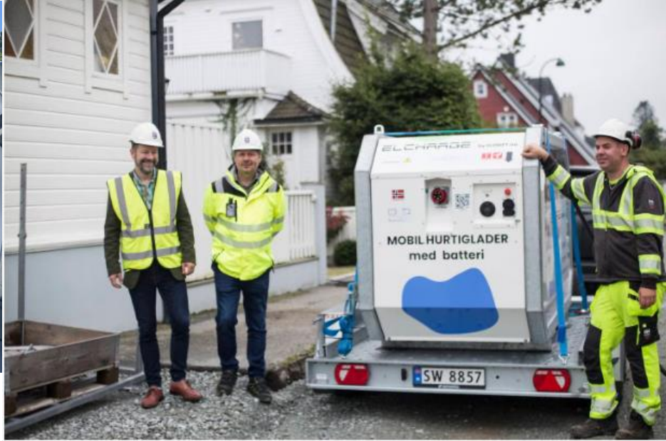
Denne hurtigladeren gjør at gravemaskinen alltid har tilgang på mer strøm, om det blir behov. (Tonette N. Haaland)
