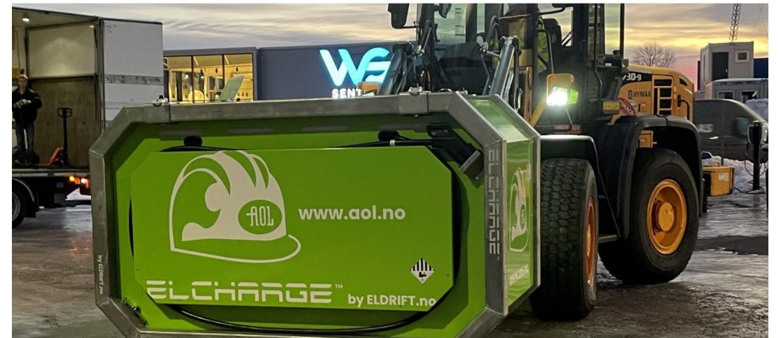
Denne hurtigladeren gjør at gravemaskinen alltid har tilgang på mer strøm, om det blir behov. (Tonette N. Haaland)
