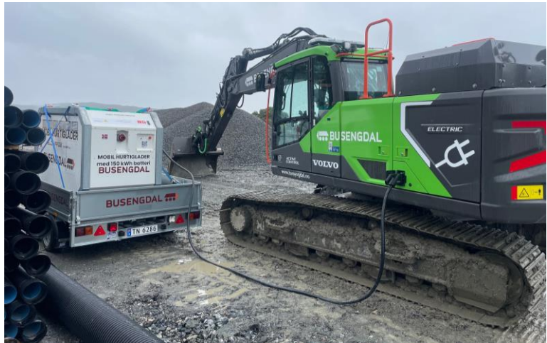
Denne hurtigladeren gjør at gravemaskinen alltid har tilgang på mer strøm, om det blir behov. (Tonette N. Haaland)
